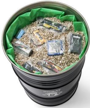
Après chaque couche de piles au lithium, verser une couche de vermiculite. Répéter ce processus jusqu'à ce que le fût soit plein.
