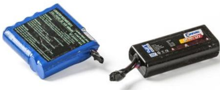
Isoler les pôles des piles au lithium au moyen d'un ruban adhésif afin d'éviter tout court-circuit.
